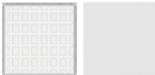
Pannello LED 600 x 600 mm, 30 W, 120 lm/W, UGR22, IRC80. Affidabile (L80B10 a 50000 ore) ed efficiente. Ideale per applicazioni commerciali e generiche. Incasso o montaggio in superficie (cornice ACC015 opzionale). Morsettiera precablata inclusa.
